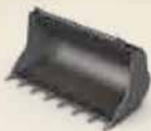
Cuchara recta para roca con dientes y segmentos
